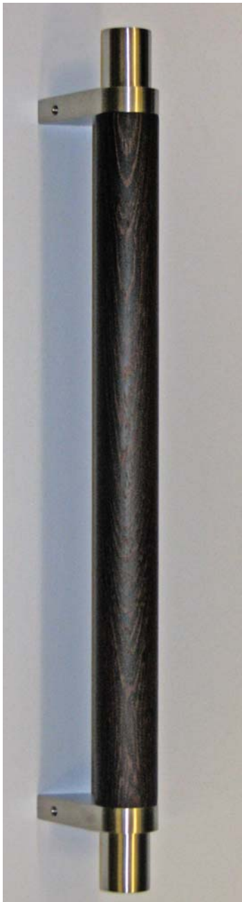
700-252 Türgriff Holz und Edelstahl Rohr \varnothing 30x2mm, L 500mm (Länge auch frei wählbar) Stützen schräg oder gerade LA 415mm Holzart "Wenge", geölt \varnothing 40mm, L 400mm
